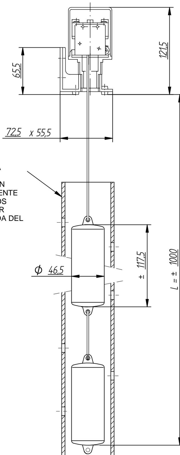
PARA LAS AGUAS CON UNOS MOVIMIENTOS O CORRIENTES, Y PARA LAS LONGITUDES CONSIDERABLES PROTEGER LOS FLOTADORES CON UN TUBO POR EJ. DE 2 1/2". ES CONVENIENTE QUE ESTE TUBO TENGA PRACTICADOS ALGUNOS ORIFICIOS DE  $\varnothing 10$  mm POR EJEMPLO, PARA FACILITAR LA ENTRADA DEL AGUA EN EL TUBO.
